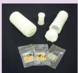
キャプセル(奥)と照射試料(手前)
