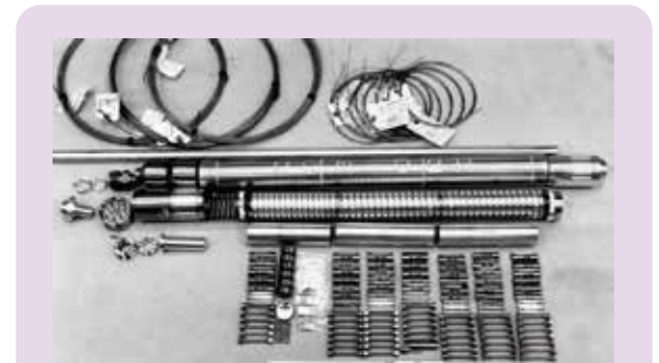
照射キャプセル(奥)と照射試験片(手前)
